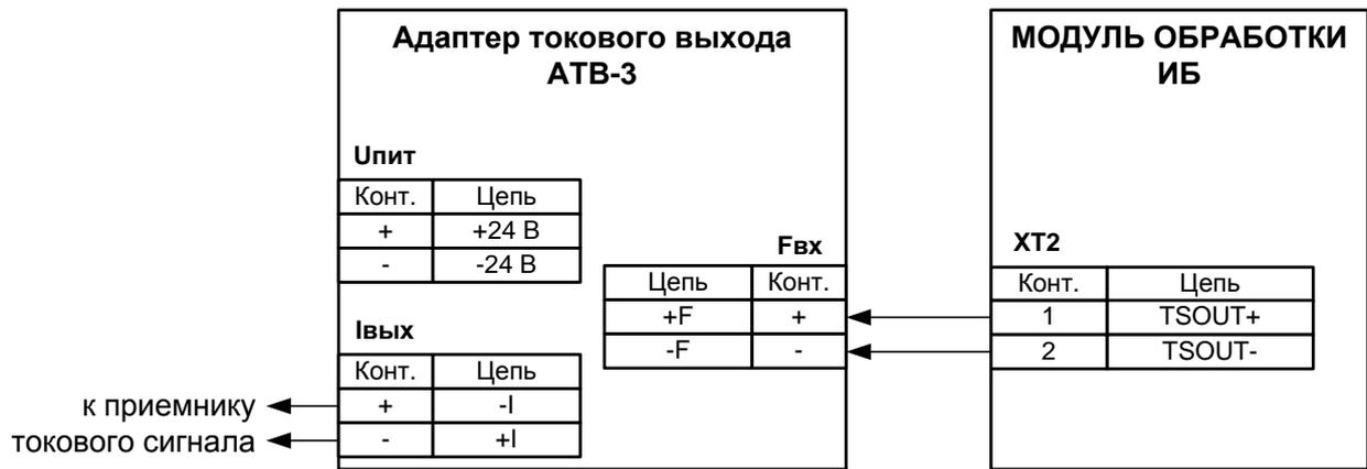
**Рис. Г.2. Схема подключения адаптера.**
