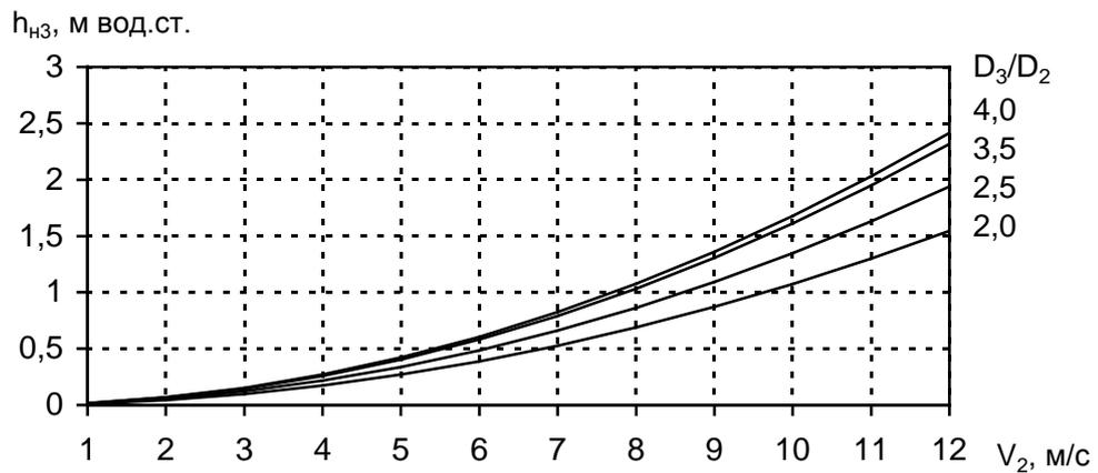
Рис.4. Графики зависимостей потерь напора в конфузоре (а), прямолинейном участке (б) и диффузоре (в).
