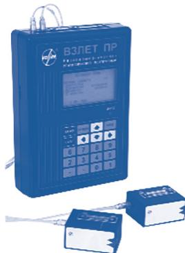
Предназначен для оперативного измерения расхода жидкости с помощью накладных датчиков без вскрытия трубопровода. Измерение возможно в напорных металлических и пластмассовых трубопроводах в различных условиях эксплуатации, а также во взрывоопасных зонах.
