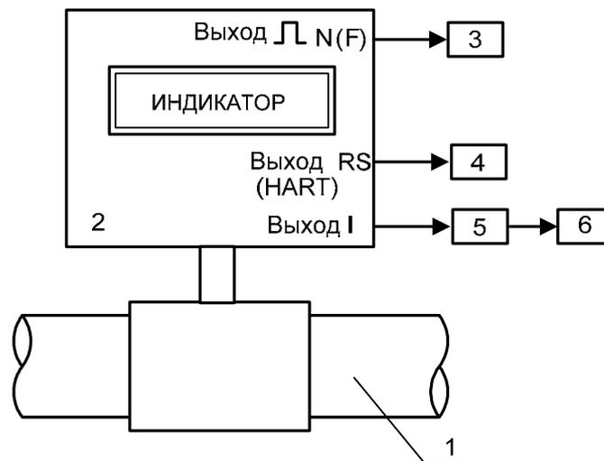
1 – трубопровод поверочной установки; 2 – расходомер; 3 – счетчик импульсов (частотомер); 4 – персональный компьютер; 5 – магазин сопротивлений; 6 – вольтметр.
