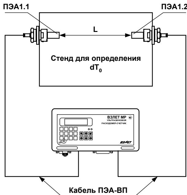
Рис. К.1. Определение смещения  $dT_0$  с помощью стендa.
